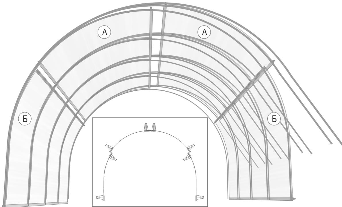
Сначала вставляем сдвижную секцию (Б) в нижний паз направляющей и сдвигаем по направляющей на противоположную сторону каркаса. Затем вставляем две сдвижные секции (А) в верхний паз направляющей и сдвигаем на середину каркаса. Затем снова вставляем сдвижную секцию (Б) в нижний паз направляющей.
