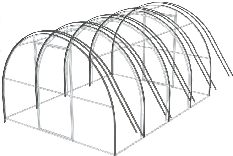
Возьмите еще по 2 части направляющей крыши (30) и защелкните их с одной стороны теплицы. С другой стороны оставьте незащелкнутыми для удобства монтажа подвижных секций.
