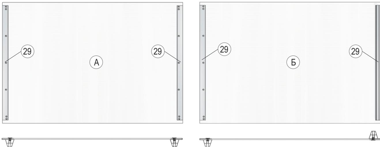
На каждый пролёт (1 метр) подготавливаем две сдвижную секцию с двумя ручками, направленными в одну сторону (А) и две сдвижную секцию с двумя ручками, направленными в разные стороны (Б).
