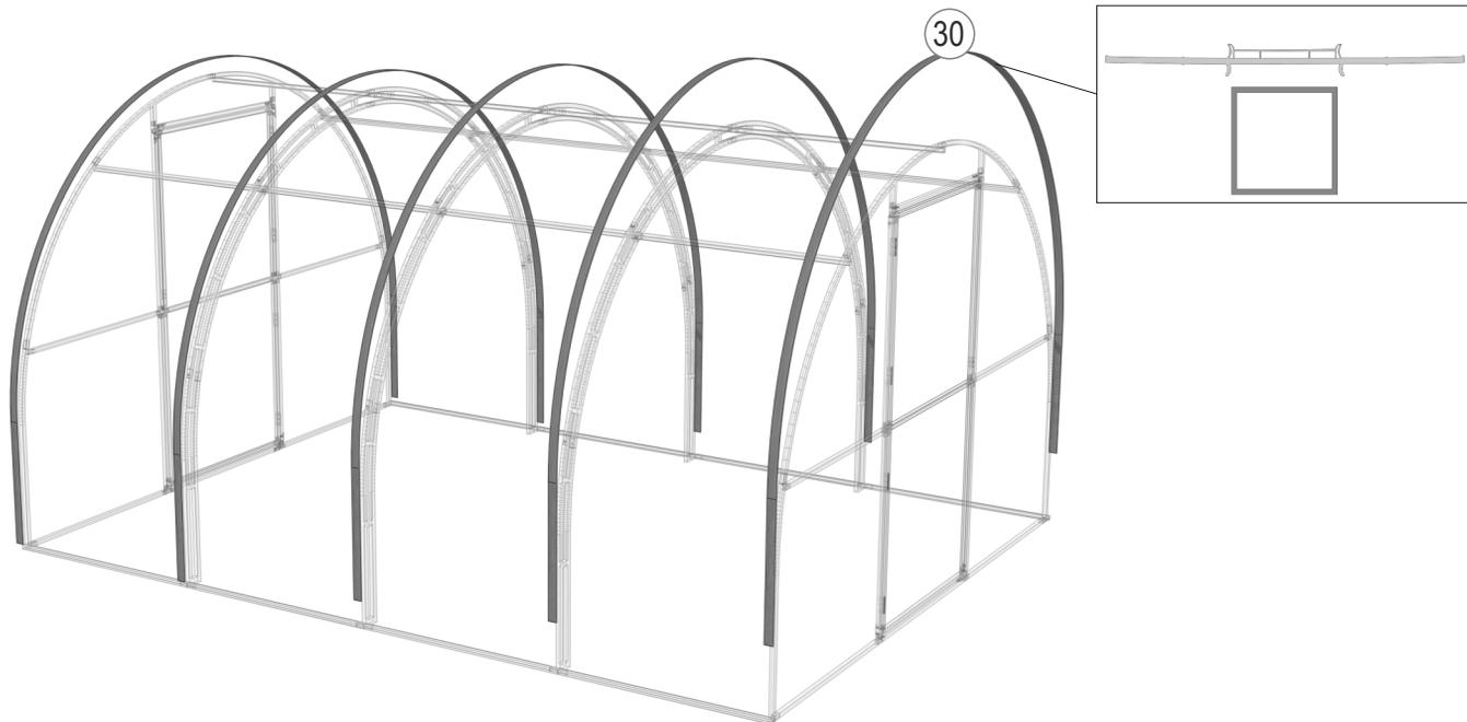
Возьмите одну часть направляющей крыши (30), разместите на каждой дуге узким замком вверх и закрепите саморезами 4.2x19 (26) в местах согласно рисунку на странице 21.
