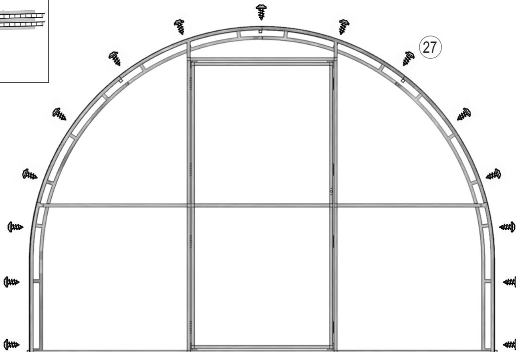
Затем защелкиваем все части направляющей между собой и проверяем что секции свободно двигаются и ручки не мешают друг другу. Закрепляем направляющие саморезом 4,2x25 (27) в местах, указанных на рисунке.
