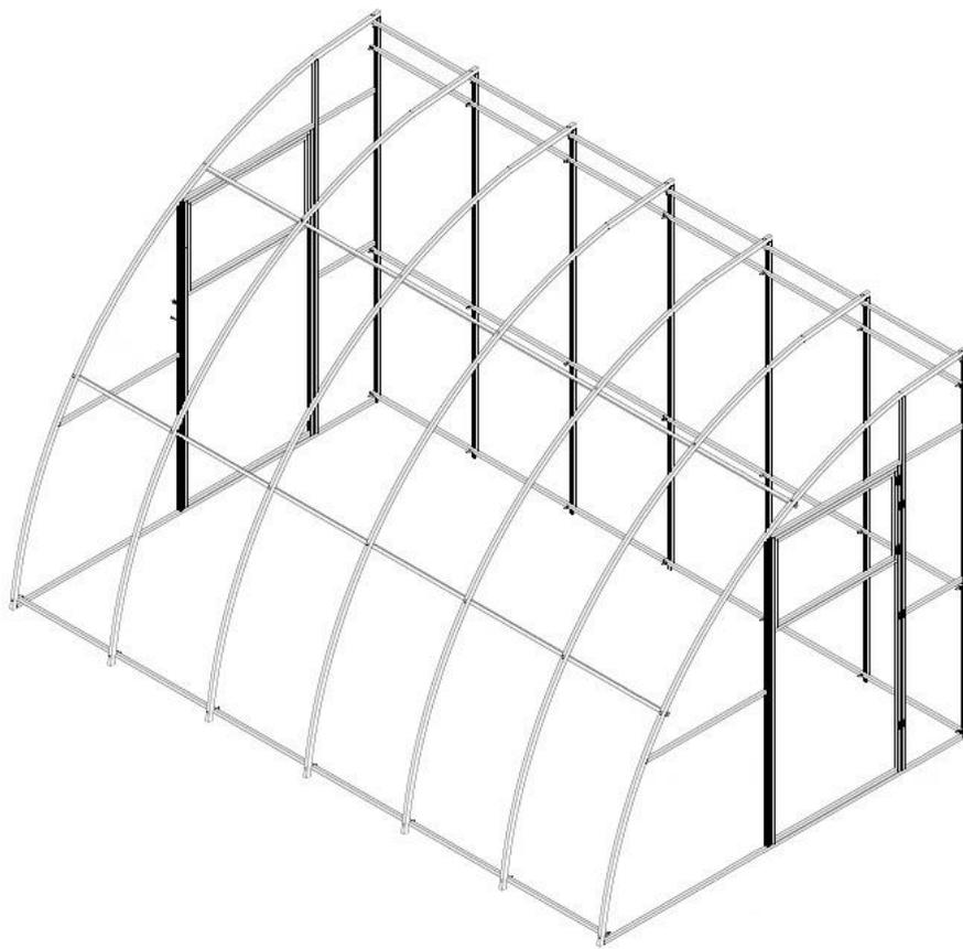
*Рис. 1 Схема компоновки «Базового комплекта теплицы 4м».*
