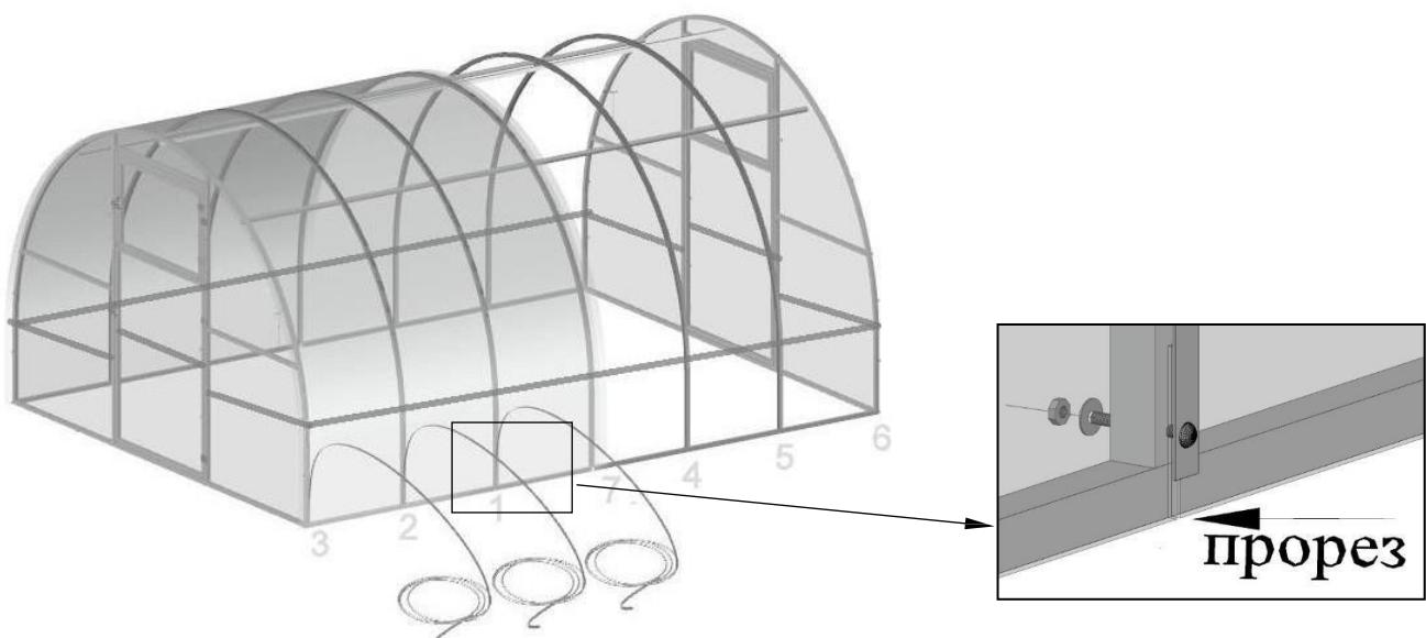
«Закрепите короткую ленту с другой стороны теплицы следующим образом - выровняйте длину выступа листа поликарбоната с обоих краев и сделайте надрез для болтового соединения. Выкрутите болт из дуги и вставьте обратно через ленту (см. Рис. 9).»
