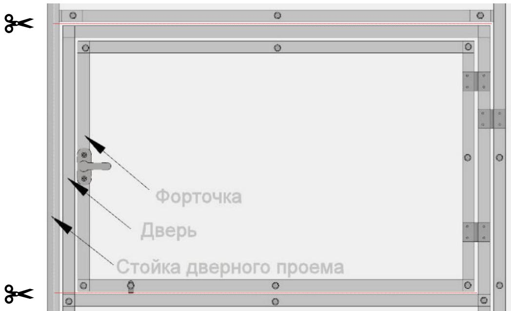
Для теплицы **Добриня** – сборка первого Торца закончена. Вырежьте и закрепите аналогично лист поликарбоната с другого края листа для второго Торца (Деталь Б). Аналогично установите фурнитуру. Примкните остаток поликарбоната и закрепите по схеме кровельными саморезами (см. Рис. 1,2 Добриня) Детали «В» и «Г» с перекрытием на 2/3 ширины стойки дверного проема.
