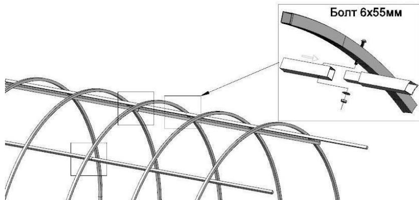
Теперь соедините направляющие с Торцом. Закрепите Нижние направляющие саморезами 4,2x19, а верхние направляющие болтовым соединением (болт М6х55, гайка, шайба).
