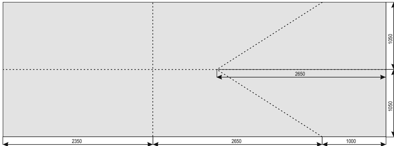
Разметьте лист согласно рисунку. Затем ровно по линиям разрежьте сотовый поликарбонат при помощи монтажного ножа или другого инструмента. Защитную пленку во время данной операции снимать не надо. Пометьте листы с наружной стороны маркером.
