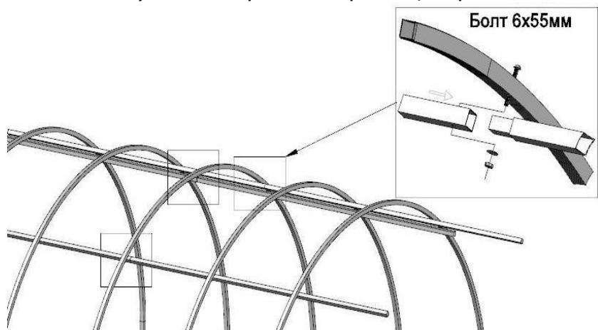
Теперь соедините направляющие с Торцом. Закрепите Нижние направляющие саморезами 4,2x19, а верхние направляющие болтовым соединением (болт М6x55, гайка, шайба).
