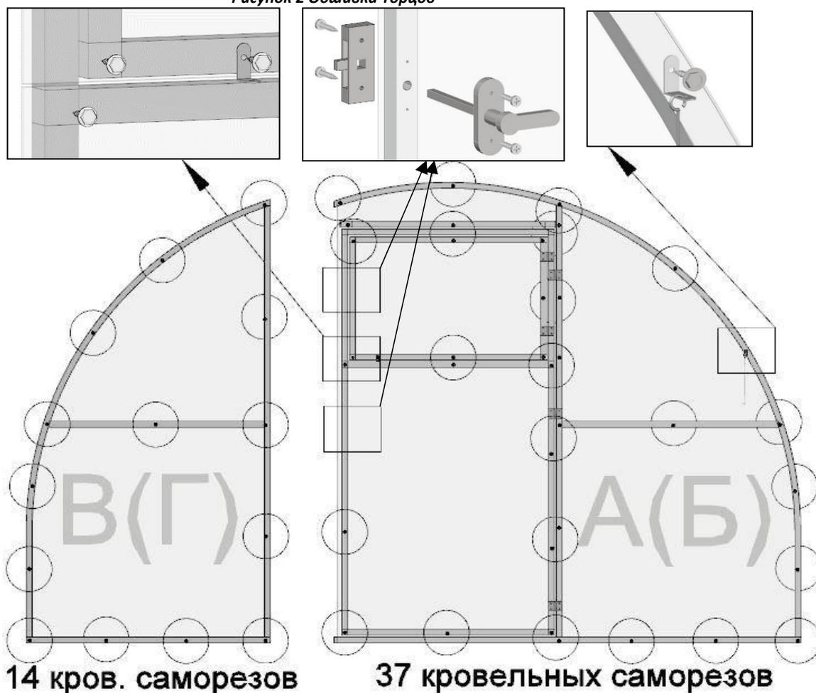
Для установки ручек на стойках двери и дверного проема подготовлены отверстия. Приложите Замок изнутри и вставьте снаружи Ручку со штоком в отверстие (подготовьте отверстие в поликарбонате). Прикрепите саморезами 4,2x19 Ручку, с противоположной стороны прикрепите Замок.
