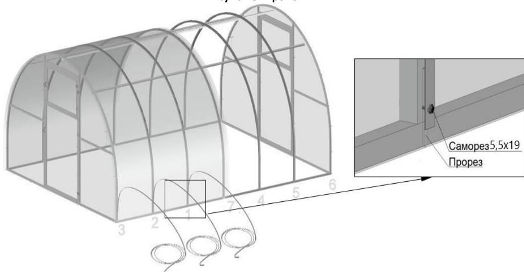
«Закрепите короткую ленту с другой стороны теплицы следующим образом - выровняйте длину выступа листа поликарбоната с обоих краев и сделайте надрез для самореза. Прикрепите короткую ленту на кровельный саморез 5,5x19 (см. Рис. 9).
