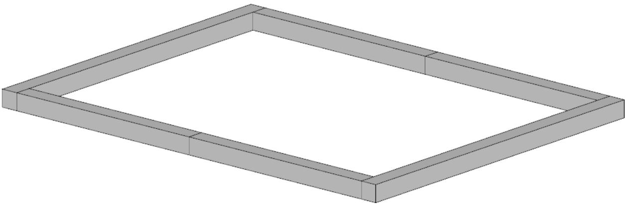
Каркас теплицы крепится к брусу при помощи саморезов, либо гвоздей. Торцы теплицы рекомендуем выставить посередине бруса, продольное расположение рекомендуем устроить по внешнему краю бруса, что позволит опустить лист поликарбоната внахлест фундамента.
