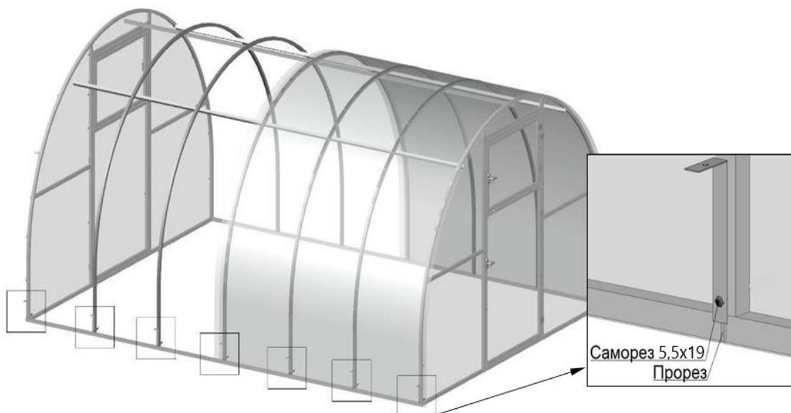
Осторожно перекиньте длинную ленту через каркас и выровняйте ленту ровно над Дугой. Соедините с короткой лентой с помощью стяжного болта 6x55, шайбы и гайки как показано на Рис. 10. Порядок установки лент указан на Рис. 8.
