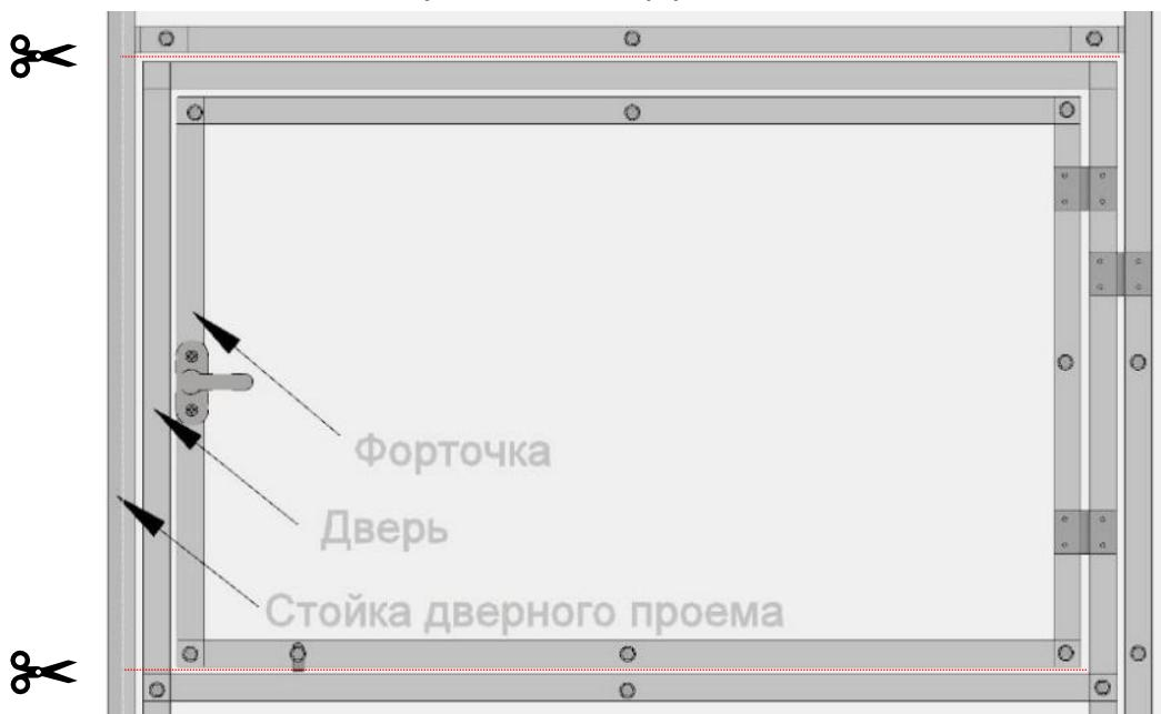
Для теплиц **Агроном** – сборка первого Торца закончена. Вырежьте и закрепите аналогично лист поликарбоната с другого края листа для второго Торца (Деталь Б). Аналогично установите фурнитуру. Примкните остаток поликарбоната и закрепите по схеме кровельными саморезами (см. Рис. 1,2 Агроном) Детали «В» и «Г» с перекрытием на 2/3 ширины стойки дверного проема.
