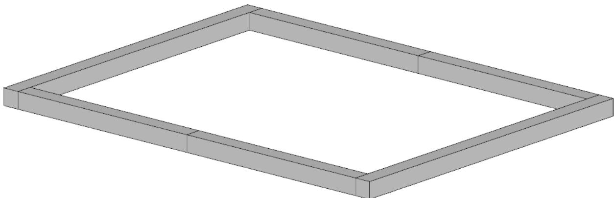
Каркас теплицы крепится к брусу при помощи саморезов, либо гвоздей. Торцы теплицы рекомендуем выставить посередине бруса, продольное расположение рекомендуем устроить по внешнему краю бруса, что позволит опустить лист поликарбоната внахлест фундамента.
