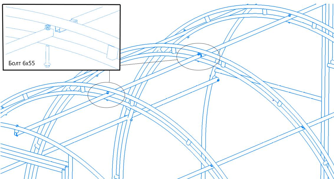
Теперь соедините направляющие с Торцом. Закрепите Нижние направляющие саморезами 4,2x19, а верхние направляющие болтовым соединением (болт М6x70, гайка, шайба) показанного на рис. 7.
