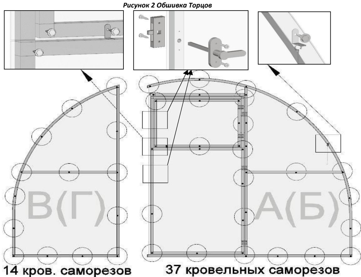
Для установки ручек на стойках двери и дверного проема подготовлены отверстия. Приложите Замок изнутри и вставьте снаружи Ручку со штоком в отверстие (подготовьте отверстие в поликарбонате). Прикрепите саморезами 4,2x19 Ручку, с противоположной стороны прикрепите Замок.
