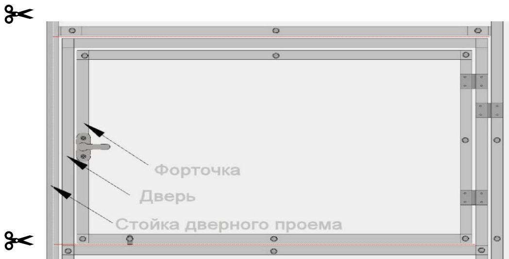
Для теплицы **Прогресс** – сборка первого Торца закончена. Вырежьте и закрепите аналогично лист поликарбоната с другого края листа для второго Торца (Деталь Б). Аналогично установите фурнитуру. Примкните остаток поликарбоната и закрепите по схеме кровельными саморезами (см. на Рисунок. 1,2 ) Детали «В» и «Г» с перекрытием на 2/3 ширины стойки дверного проема.
